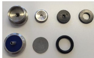
7 pav. Įleidimo anga yra atskirta visose dalyse.
